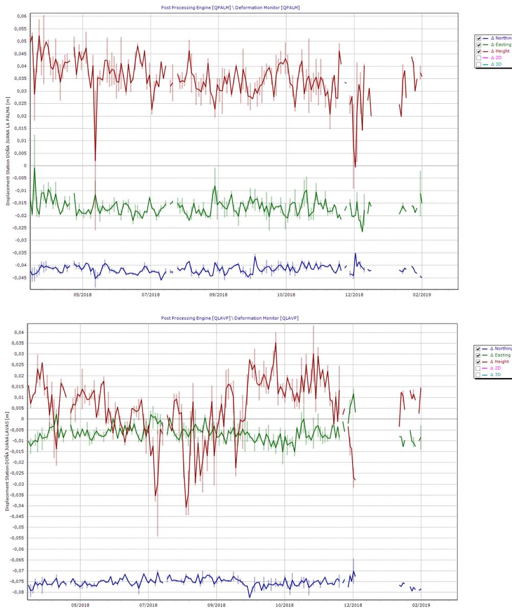
**Figura 83.** Variaciones en las direcciones Norte, Este y Altura de las estaciones GNSS Permanentes La Palma y Lavas instaladas sobre la superficie del volcán Doña Juana, para el periodo comprendido entre el 1 de marzo de 2018 y el 15 de febrero de 2019.
