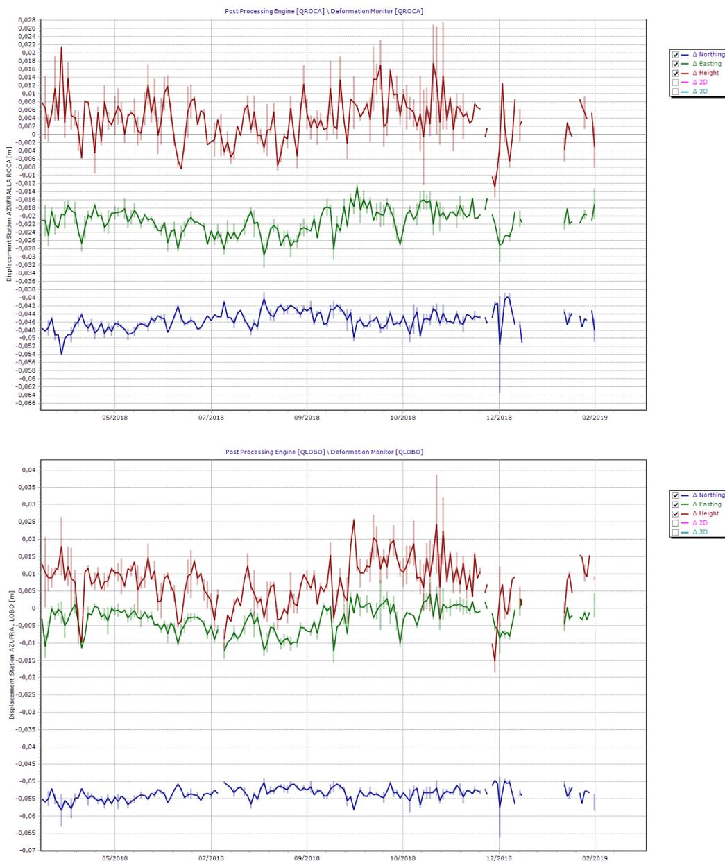
**Figura 91.** Variaciones en las direcciones Norte, Este y Altura de las estaciones GNSS Permanentes La Roca y Lobo instaladas sobre la superficie del volcán Azufral, para el periodo comprendido entre el 1 de marzo de 2018 y el 15 de febrero de 2019.
